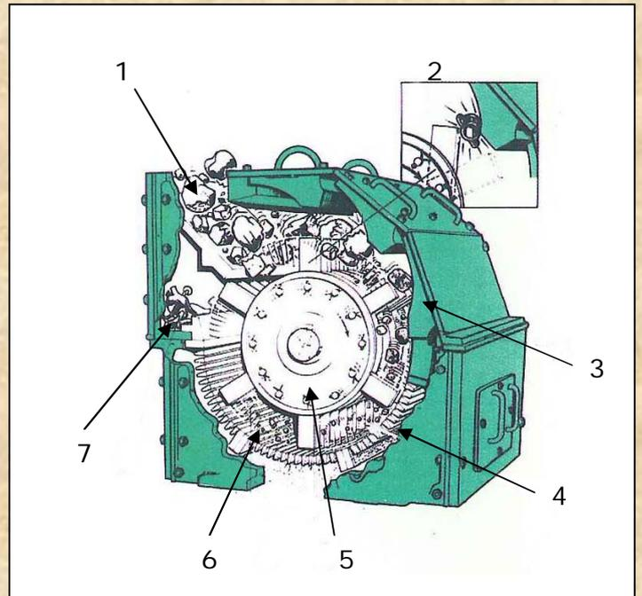
6. 半円形をしたスクリーンは、粉砕品の粒子の大きさにより、開口径を選定します。スクリーンは、前面ドアの上から入り、マシン側面フレームにあたる溝に沿ってスライドしていきます。
